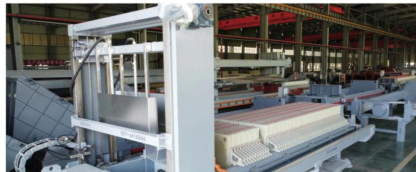
Устройство устанавливается сверху фильтр-пресса. Оно состоит из направляющего рельса, корзины для мойки, механизма перемещения корзины для воды, трубы подачи воды, тяговой цепи, трубы для мойки, сопла, устройства подъема трубы для мойки, мотора замедления и т. д. Он может завершить стирку ткани в сотрудничестве с устройством перемещения пластин под управлением ПЛК. Эта система позволяет смыть остатки фильтрационной корки с сетки под напором воды.
